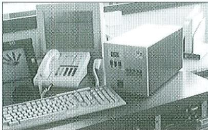
*Le terminal SIGMA comprend un clavier, un écran et une imprimante de strip.*
